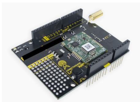
Figura 6: Shield com Módulo Lorawan
