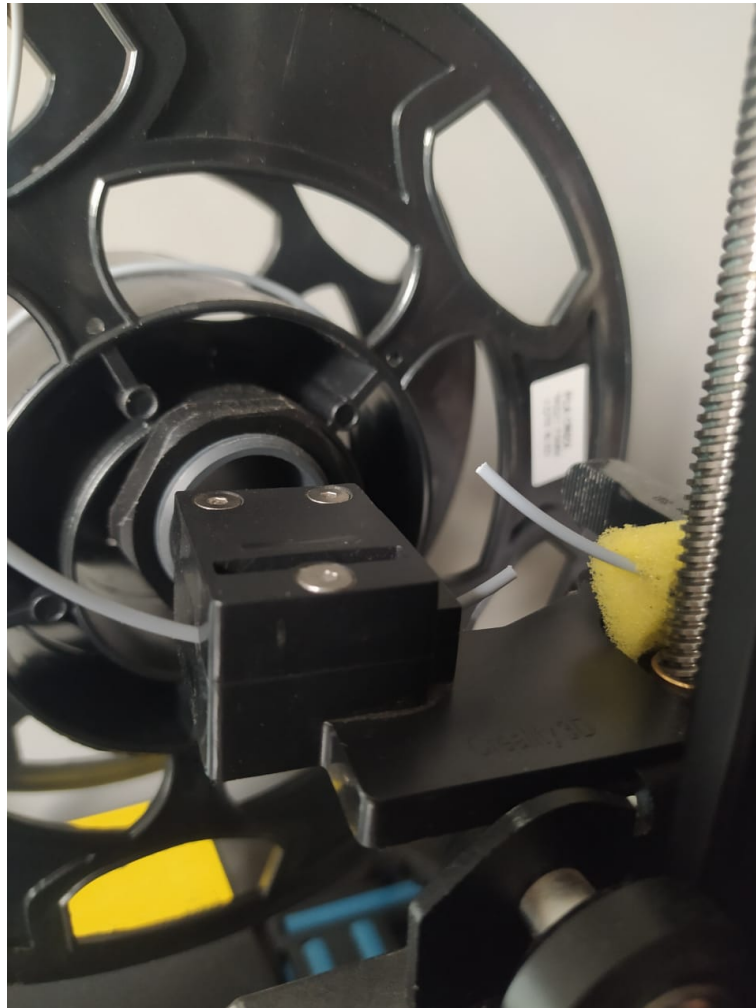
Figura 3.3.4: Deve-se tomar cuidado para não quebrar o filamento.
