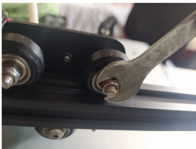
Figura 4.3.4: Aperto das partes deve estar firme.
