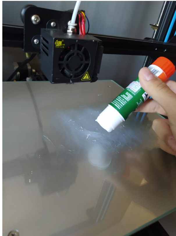
Figura 3.5.2: Aderência da impressão pode ser melhorado com uma cola bastão comum.
