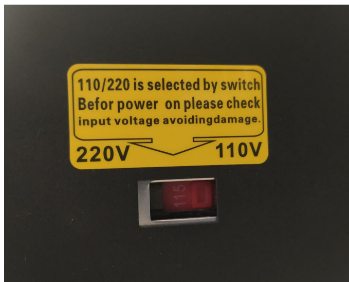
Figura 4.1.3: Sempre selecione a tensão de 110V se estiver em Minas Gerais.
